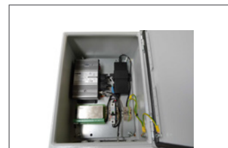
T8 reläenhet i väggskåp med infästning och kablage för Sepura SRG (radioenhet ingår ej)
